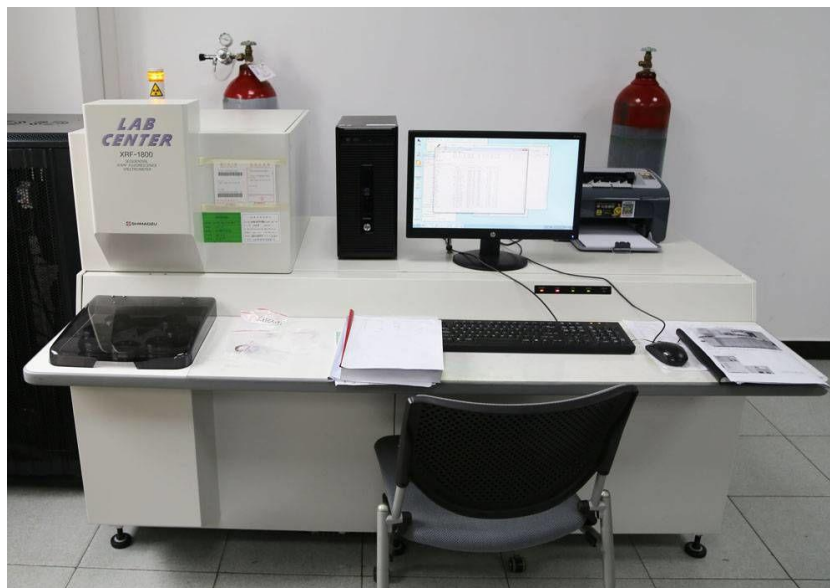
Сурет 3.20 – XRF-1800 рентгендік флуоресцентті толқындық дисперсиялық спектрометрі
