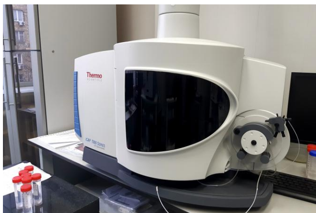
Сурет 3.21 – iCAP 7200 индуктивті байланысқан плазмалық атомдық-эмиссиялық спектрометрінің сыртқы бейнесі
