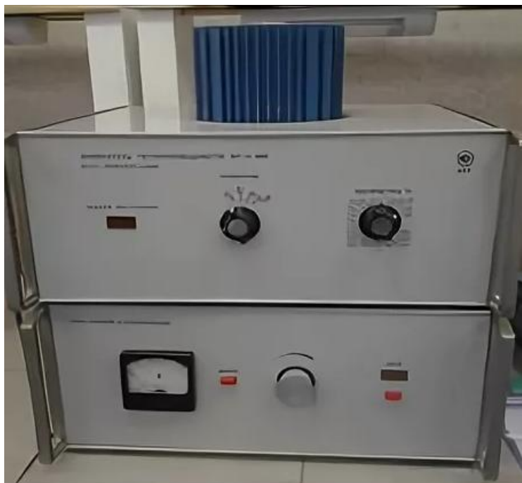
Сурет 4.1 – «ИТ-λ-400» жылу өткізгіштік коэффициентін зерттеуге арналған тәжірибелік қондырғы
