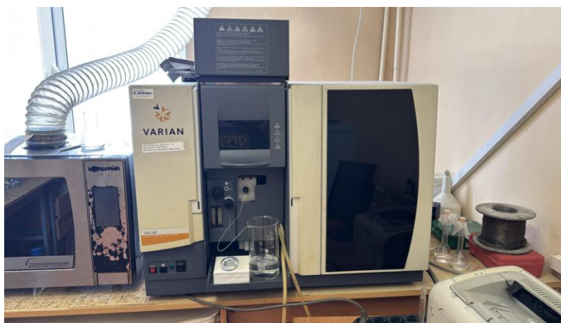
Сурет 3.17 – AA140 атомдық абсорбциялық спектрометр
