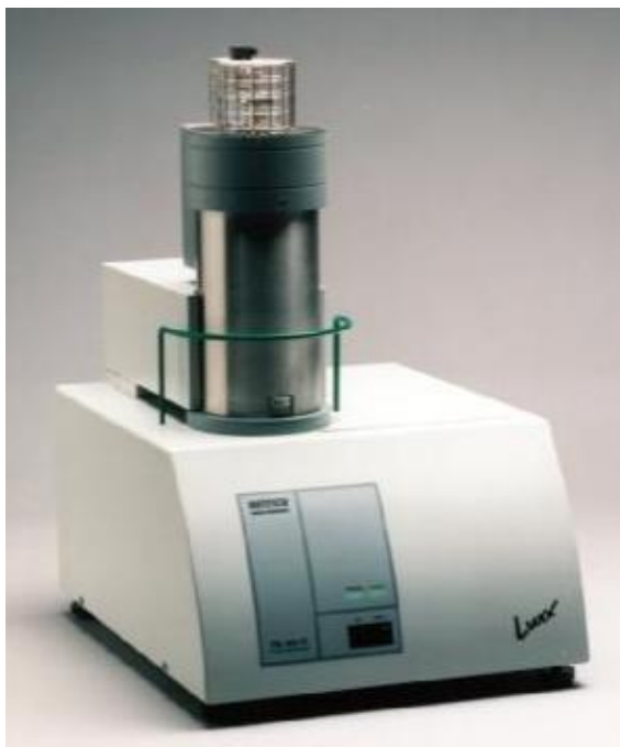
Сурет 4.10 – STA409PC синхронды термоанализатор
