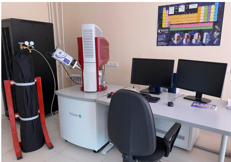
Сурет 3.5 – Tescan Mira 3 сканерлейтін электронды микроскоп
